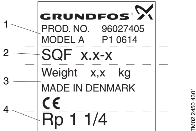
Fig. 1 Placa de características, bomba de rotor helicoidal
