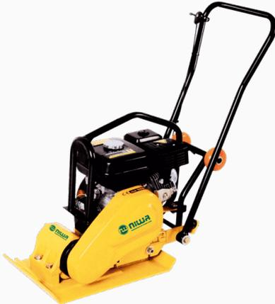
La plancha compactadora de 60 kg y 5,5 HP de 0,36 m de ancho, ideal para trabajos pequeños de compactación hasta 0,20 m de espesor de suelo.
