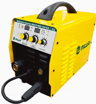
Equipo MIG multiproceso, 3 en 1 (MIG/MMA/TIG por LIFT ARC), muy compacto y fácil de transportar. Este equipo es ideal para una pequeño taller, cerrajería o empresas de mantenimiento. Puede usarse con alambre macizo o tubular de 0,6/0,8/0,9/1 mm.
