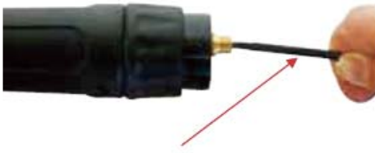
(5) Cuidadosamente coloque el liner sin doblarlo
