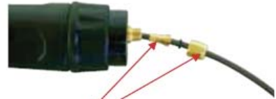
(6) Coloque la abrazadera, el o 'ring y la tuerca
