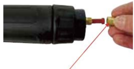
(2) Retire la tuerca del liner
