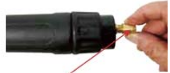
(6) Ajuste solo ½ vuelta la turca del liner
