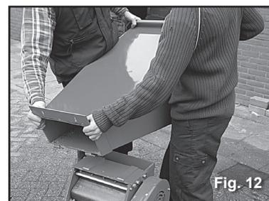
Deslice el macho de las bisagras en la hembra de la misma en la caja de trituración.
