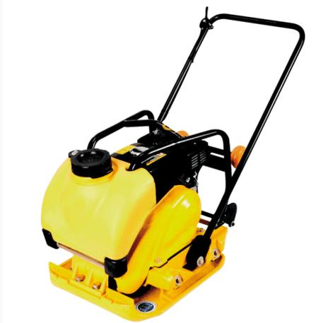
El motor Robin de 5,0 HP hace de esta plancha compactadora con tanque de agua de 97 kg una excelente opción para trabajos de bacheo en pavimentos de asfalto, así como para trabajos de compactación hasta 0,30 m de espesor de suelo. Puede usarse en zanjas de 0,50 m de ancho.
