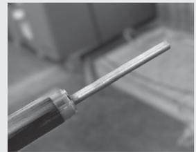
**P13.** Colocar la barra de magnesio en el primer tubo (del lado contrario a la ubicación del kit eléctrico).
