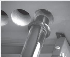
**P11.** Colocar primero el tubo en la del tanque girando lentamente hacia arriba en sentido horario.
