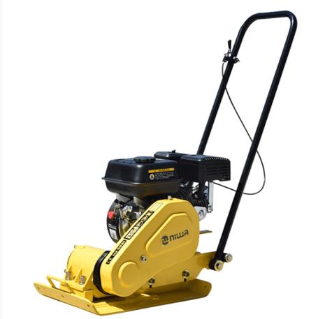
Esta plancha compactadora de 60 kg con el eficiente y confiable motor Robin de 5,0 HP, es ideal para trabajos pequeños de compactación hasta 0,20 m de espesor de suelo. De 0,36 m de ancho, puede utilizarse para compactar encadenados o cimentaciones corridas.
