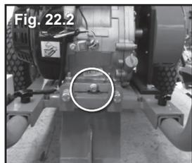
Cambie el aceite del motor tras las primeras 5 horas de funcionamiento. Cambie el aceite dos veces al año. Asegúrese de que no haya fugas de aceite. Se recomienda usar una manguera con un amarre metálico que se ajuste a la rosca del tapón de drenaje (rosca M12x1,5). (Fig. 22.1 para motores Mitsubishi, Fig. 22.2 para motores GTE)
