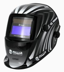
Máscara fotosensible. Con regulación de sensibilidad y tiempo de pasaje de oscuro a claro. DIN regulable 4/9-13. Área de visión 96x39 mm. Carga solar con asistencia de batería. Con modo amolado.
