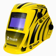
Máscara fotosensible. Con regulación de sensibilidad y tiempo de pasaje de oscuro a claro. DIN regulable 4/5-8/9-13. Área de visión 100 x 53 mm. Carga solar con asistencia de batería intercambiable. Con modo amolado.
