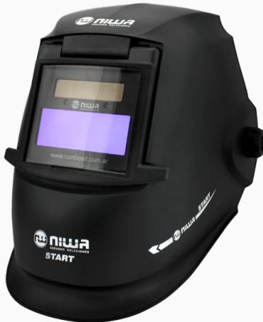
Máscara fotosensible. Sin regulación. DIN 4/13. Área de visión 91x35 mm. Carga solar con asistencia de batería. Visor rebatible para amolado.
