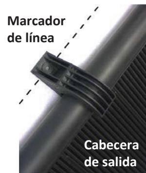
**\*Nota:** Organice el equipo de cada colector en el piso en orden contrario en el que se va a instalar, después suba el colector al techo y ubíquelo en la posición deseada, posicione la cabecera de salida hacia la parte final del lado de retorno de la hilera, y asegurando el soporte superior de la cabecera dentro de la base previamente fijada en el techo.
