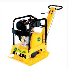
La plancha reversible con motor Robin de 5,7 HP, puede avanzar y retroceder gracias al doble excéntrico. Con 160 kg de peso , se usa para compactar hasta 0,50 m de espesor de suelo
