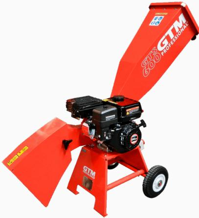
Trituradora de ramas y cultivos tanto húmedos como secos, compacta y poderosa. Ideal para empresas de jardinería y usuarios particulares muy exigentes. Tritura sin esfuerzo ramas de hasta 5 cm de diámetro gracias a su eficiente sistema de corte de dos cuchillas en un tambor rotativo de metal y una contracuchilla montada en el chasis. Incluye motor. dle
