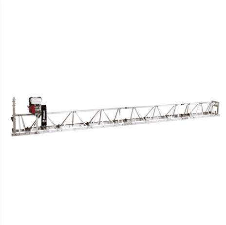
La regla vibratoria reticulada modular, de aluminio, con motor Honda de 13,0 HP y 6,00 m de longitud, puede usarse de 4,50 m o bien hasta 12,00 m agregando módulos intermedios adicionales. Es la herramienta perfecta para acompañar el hormigonado de pavimentos, dejando una terminación perfectamente horizontal, lisa y sin burbujas de aire ocluidas. Incluye dos malacates para realizar el avance con un solo operario. Puede usarse de 4,50 m quitando el modulo del medio.
