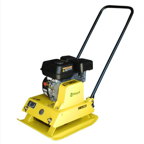
El motor Robin de 5,7 HP le confiere a esta plancha compactadora de 95 kg y 6,5 HP confiabilidad y rendimiento. Es indicada para trabajos medianos de compactación de capas de suelo hasta 0,30 m
